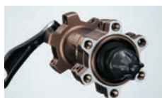
Втулка с креплением ротора на 6 болтах
